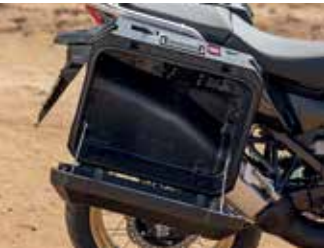
ΠΛΑΣΤΙΚΕΣ ΠΛΑΪΝΕΣ ΒΑΛΙΤΣΕΣ ΚΩΔ: 08L71-MKS-E00 Χωρητικότητα: 30 λίτρα (δεξιά), 40 λίτρα (αριστερή). Διαθέτουν ειδικές βάσεις για την Africa Twin. Με ίσιες επιφάνειες για να τοποθετηθούν επιπλέον αποσκευές. Ο χειρισμός της γίνεται με το κλειδί ανάφλεξης. Μέγιστο φορτίο: 6 κιλά. Διαστάσεις (Μ x Π x Υ): Δεξιά: 505 x 295 x 415 χιλ. Αριστερή: 505 x 330 x 415 χιλ.
